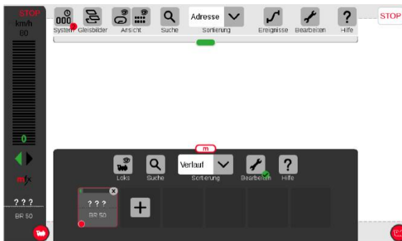
Stisknutím červeného symbolu lokomotivy se lokomotiva převzme na ovladač.
